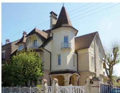
La tuile, l'ardoise, le zinc, le cuivre, les faux pans de bois en enduit, la pierre de taille, le moellon équarri ou bosselé, la brique, l'enduit, le métal, le bois sont les matériaux de construction traditionnels de ces villas manoirs.
