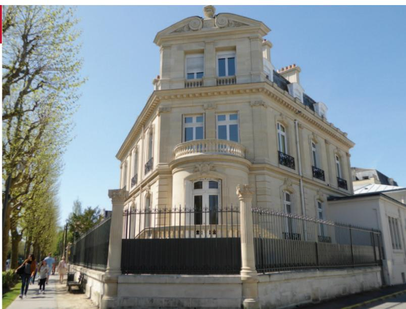
Des ferronneries agrémentent et ornent les façades des hôtels. Parfois, ce sont des garde-corps en pierre avec balustres. Les linteaux en pierre sont alignés horizontalement. Les fenêtres sont fermées par des persiennes métalliques ou par des volets en bois peint, à claire-voie. Parfois les vantaux menuisés sont intérieurs dans les embrasures.
