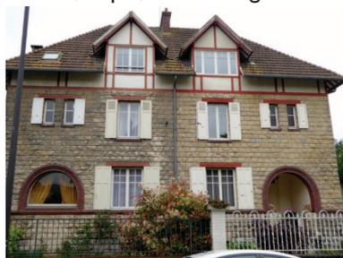
La tuile mécanique, le zinc, le cuivre, les faux pans de bois en enduit teinté, la pierre calcaire de taille ou le moellon équerri ou bosselé, la brique argile, silico-calcaire ou vernissée, la céramique, l'enduit lissé ou tyrolien, le métal, le bois sont les matériaux de construction traditionnels de ces maisons jumelles.
